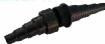
Переходник - соединитель шланга с резьбовым соединением и ёлочкой для шлангов диаметром 20 мм., 25 мм., 32 мм, 38 мм.. Удобен для соединения шлангов с различными диаметрами, для удлинения шлангов путем соединения. Для слива воды из шлангов необязательно снимать хомуты, крепящие шланги, достаточно открутить одно резьбовое кольцо.
