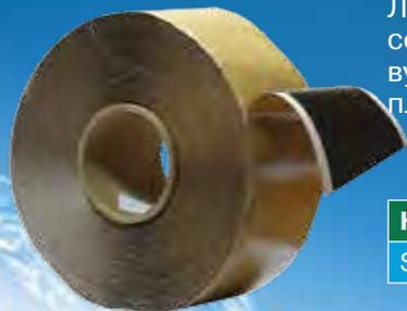
Лента SecurTape предназначена для склеивания полотен EPDM между собой. Состоит из тех же компонентов что и сама пленка, но еще не вулканизированная. После вулканизации становится одним целым с пленкой.
