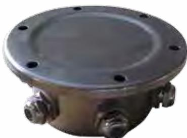
Подводная клемная коробка подходит для уличного и подводного монтажа. Применяется для упрощения монтажа и объединения в группы подводных светодиодных светильников. Корпус из литой нержавеющей стали. Степень защиты IP68. 6 кабельных вводов под кабель 5-8мм.
