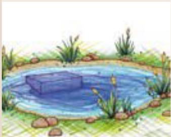
Сначала необходимо приготовить ровную и твердую поверхность для установки— фундамент, напр. бетонный пьедестал.
