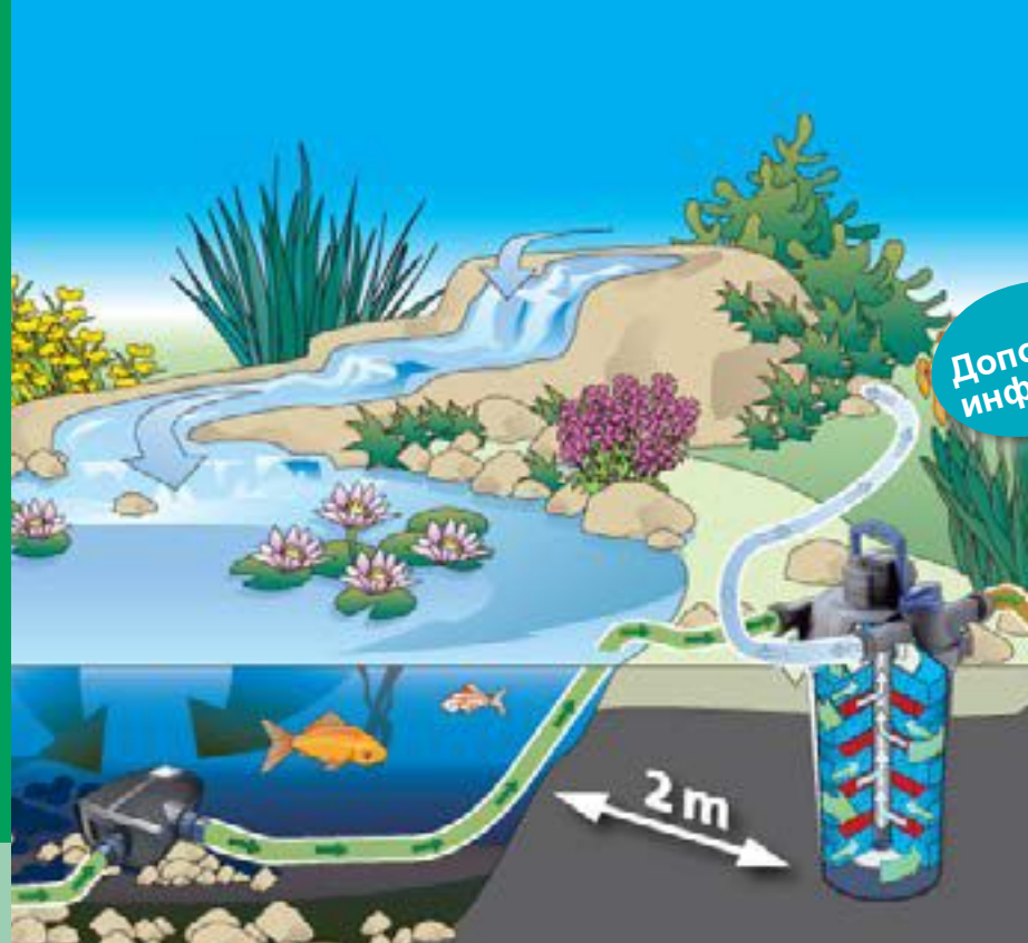
Схематическая диаграмма: Установка напорного фильтра вместе с насосом для ручья
