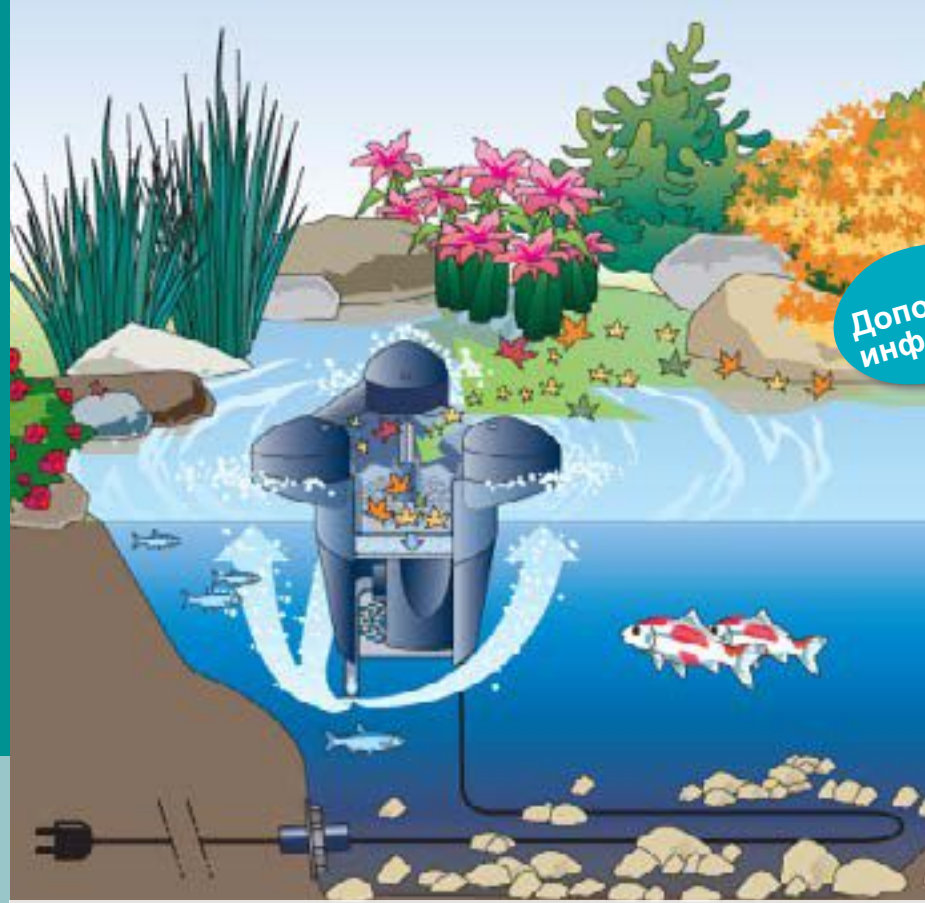
Схематическая диаграмма: использование SwimSkim 25
