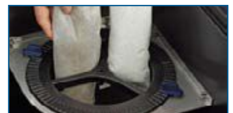
Удобное заполнение двух отдельных корзин средствами фильтрации объемом до 8 л.
