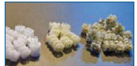
Биологическая поверхность - для колоний микроорганизмов (слева – неиспользованные поверхности, справа – заселенные бактериями).
