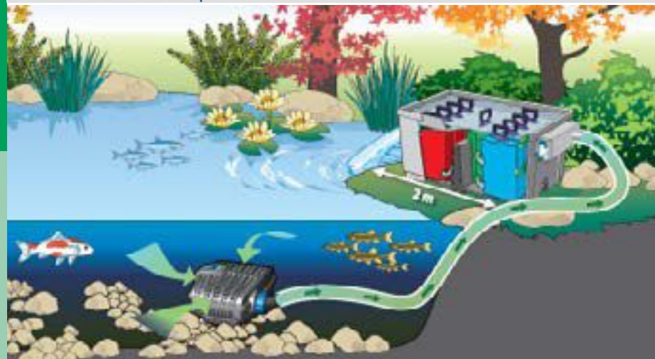
Схематическая диаграмма: BioSmart 30000 вместе с фильтром и насосом для ручьев AquaMax Eco Classic
