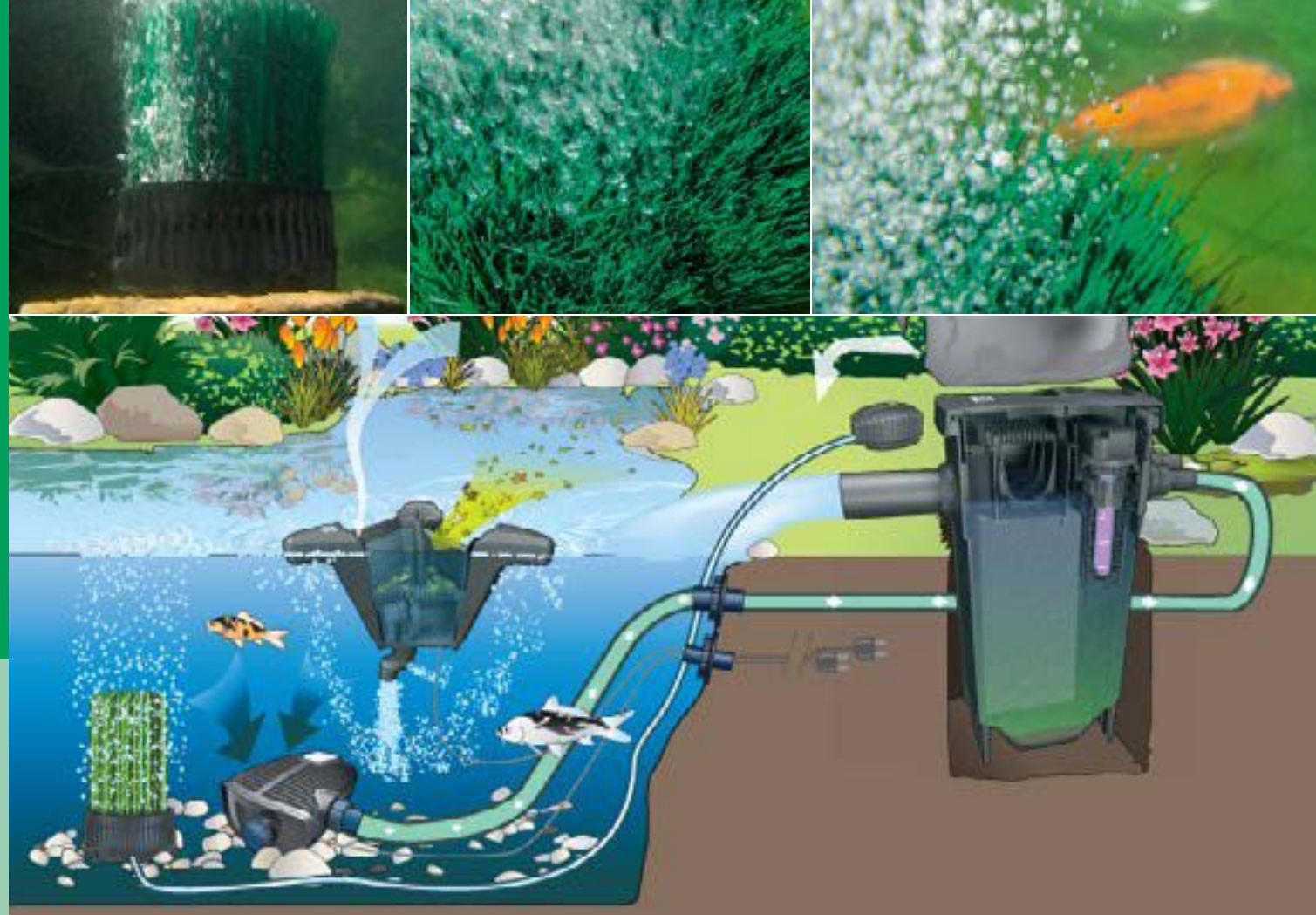
Схематическая диаграмма: Взаимодействие различных компонентов CWS (Системы с чистой водой)
