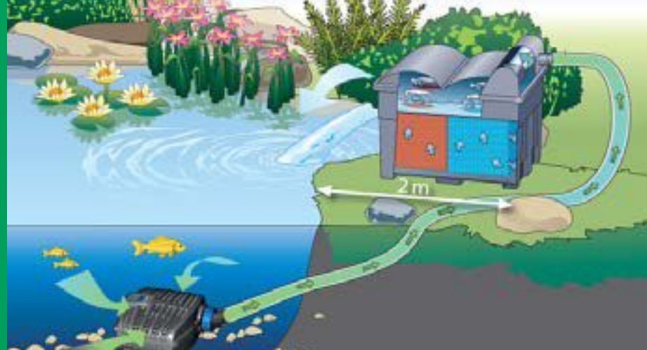
Схематическая диаграмма: BioSmart UVC 16000 вместе с фильтром и насосом для ручьев AquaMax Eco Classic
