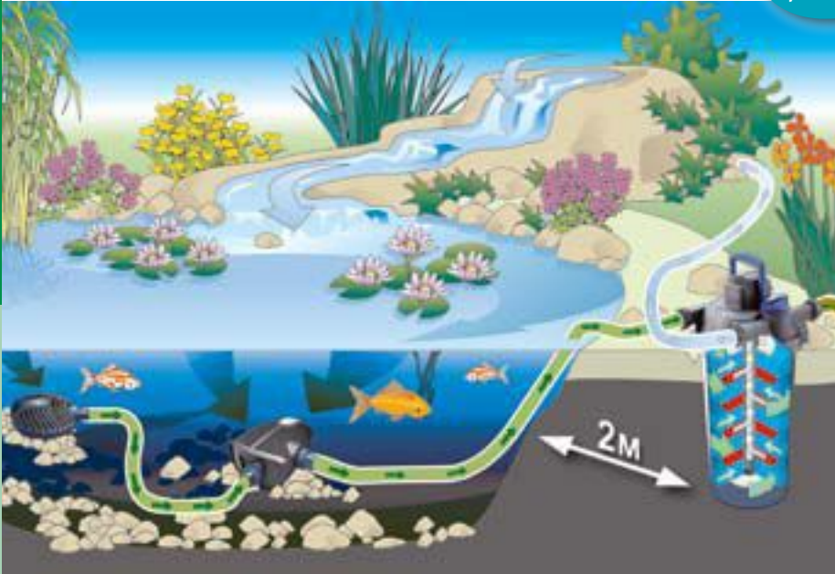
Схематическая диаграмма: Напорный фильтр FiltoClear в сочетании с насосом для фильтров и ручьев
