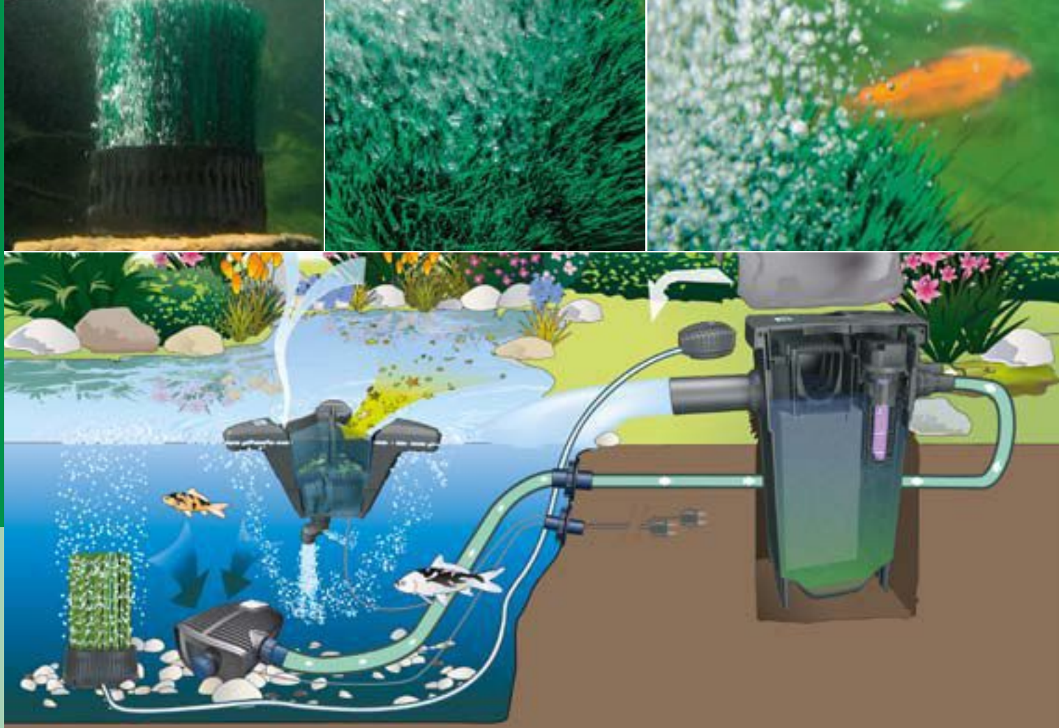
Схематическая диаграмма: Взаимодействие различных компонентов CWS (Системы чистой воды)
