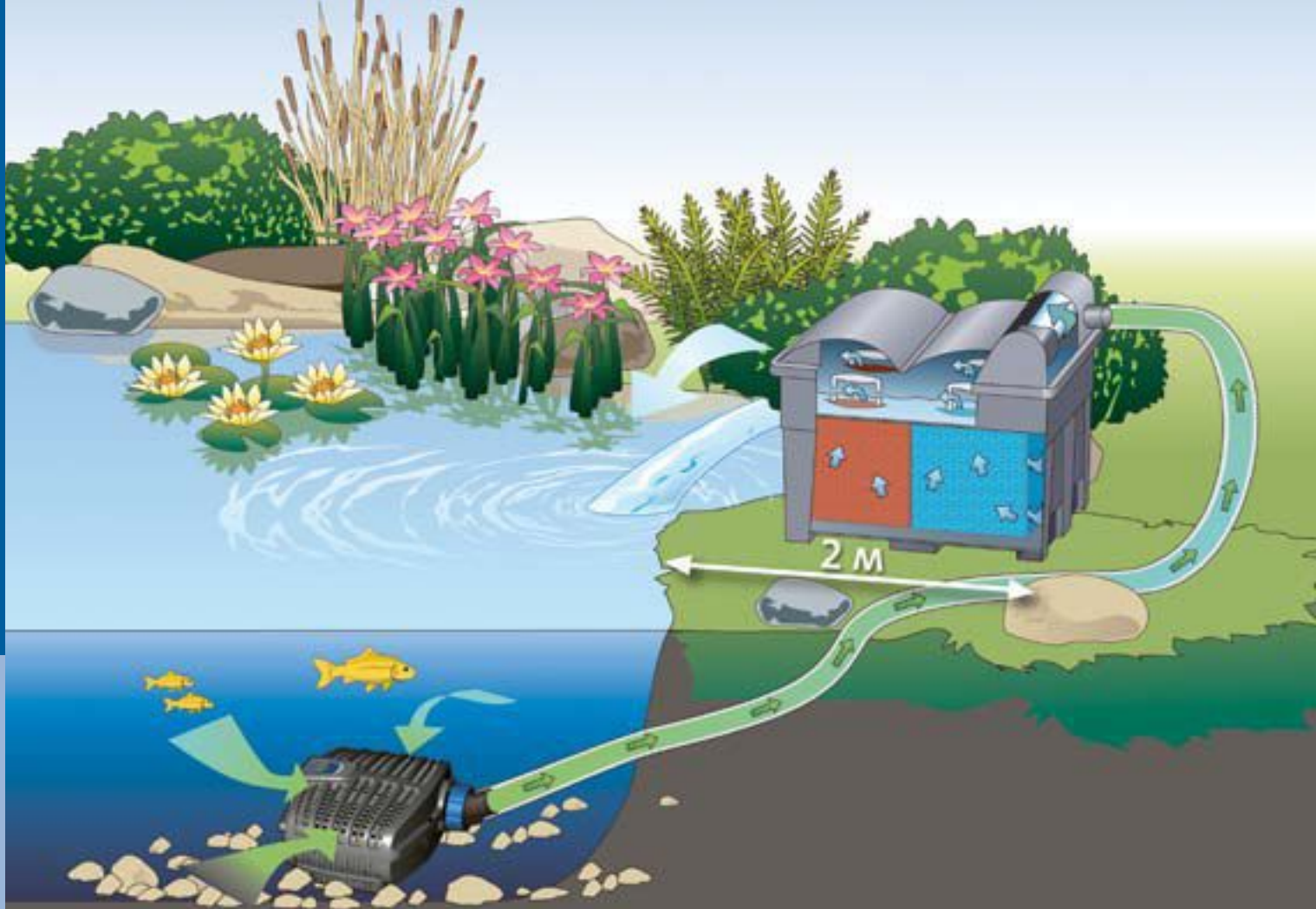
Схематическая диаграмма: Насос для фильтров и ручьев AquaMax Eco Classic (Старт) в сочетании с проточным фильтром OASE BioSmart (Старт)
