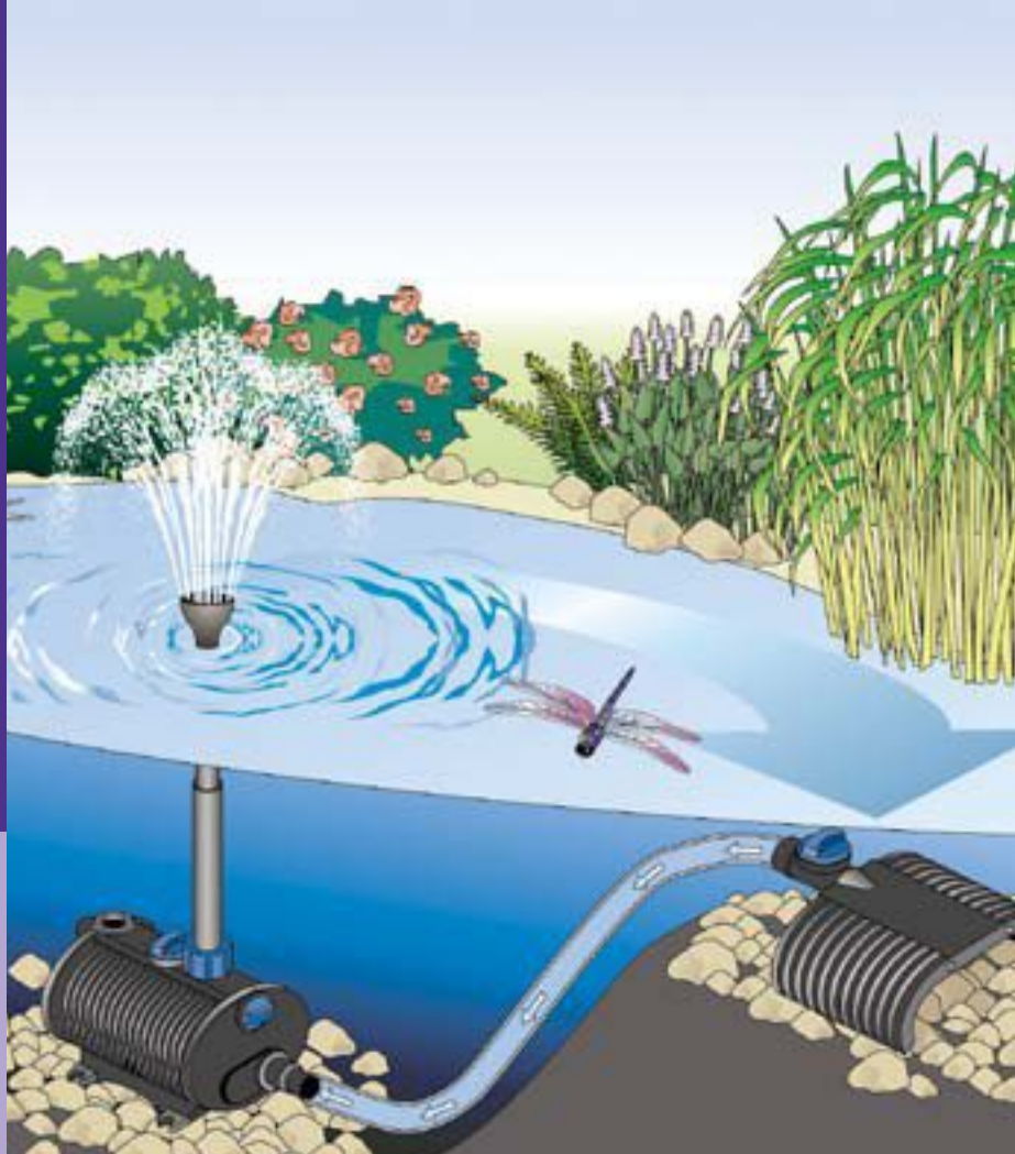
Схематическая диаграмма: Aquarius Fountain Set с отдельно установленными всасывающими крыльями
