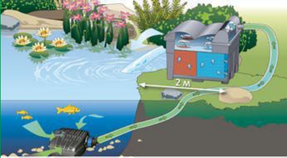
Схематическая диаграмма: BioSmart UVC 16000 вместе с насосом для фильтров и ручьев AquaMax Eco Classic
