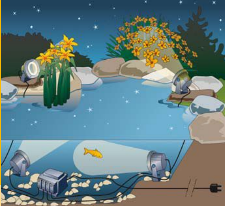
Схематическая диаграмма: использование галогенных прожекторов / светодиодных прожекторов
