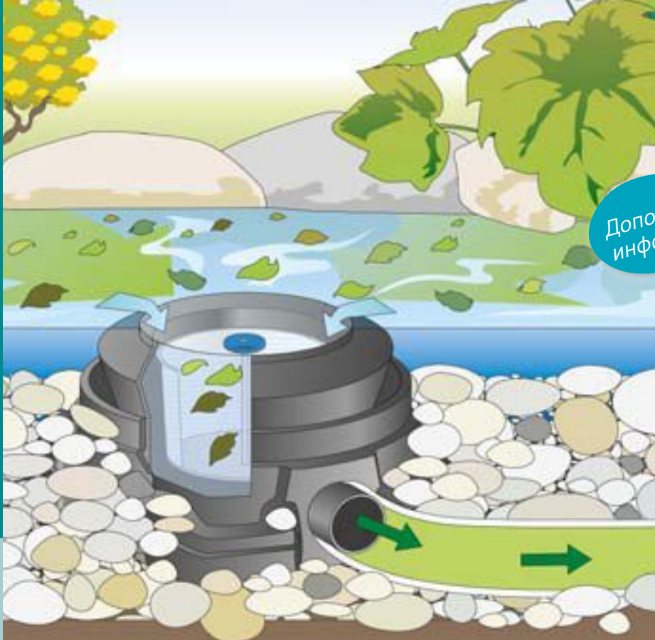
Схематическая диаграмма: Использование ProfiSkim 100
