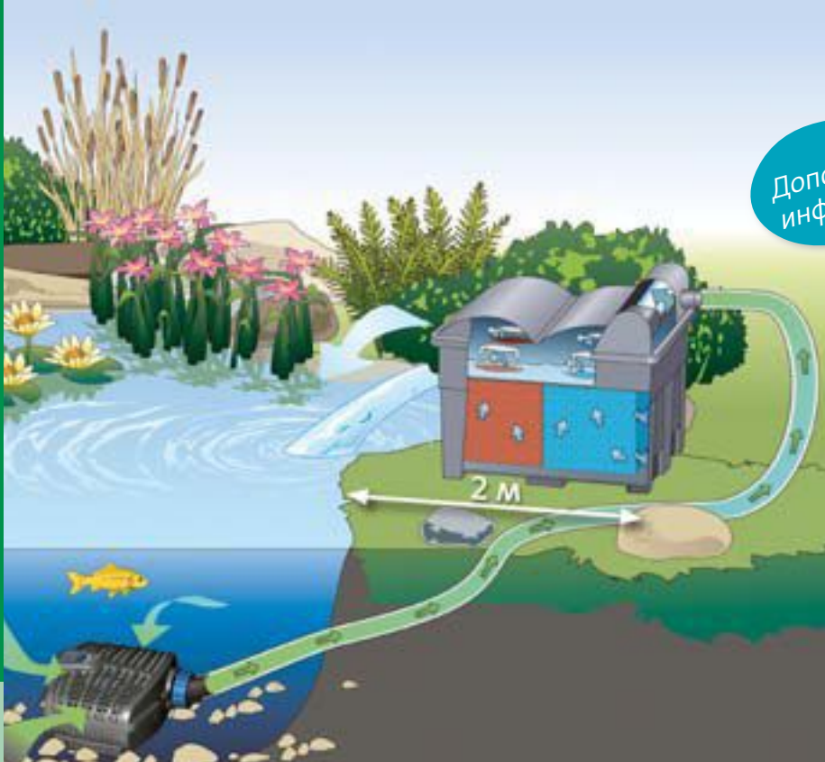
Схематическая диаграмма: комплект BioSmart Set в работе
