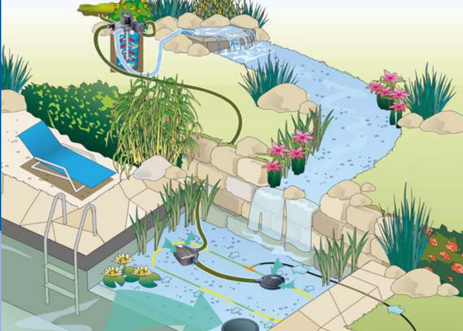
Схематическая диаграмма: Использование насоса для фильтров и ручьев AquaMax Eco Premium 12 В (Про) в сочетании с напорным фильтром OASE FiltoClear (Про)
