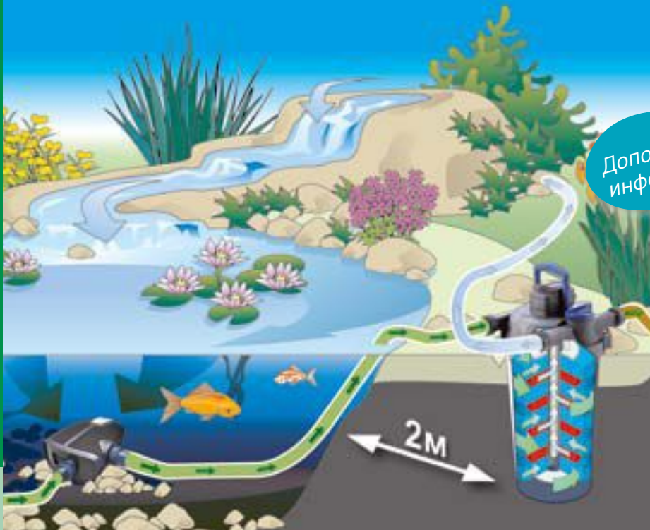
Схематическая диаграмма: напорный фильтр FiltoClear вместе с насосом для фильтров и ручьев
