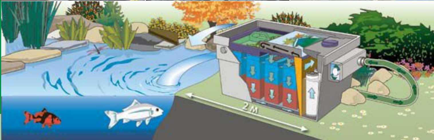
Схематическая диаграмма: УФ в сочетании с OASE BioTec ScreenMatic
