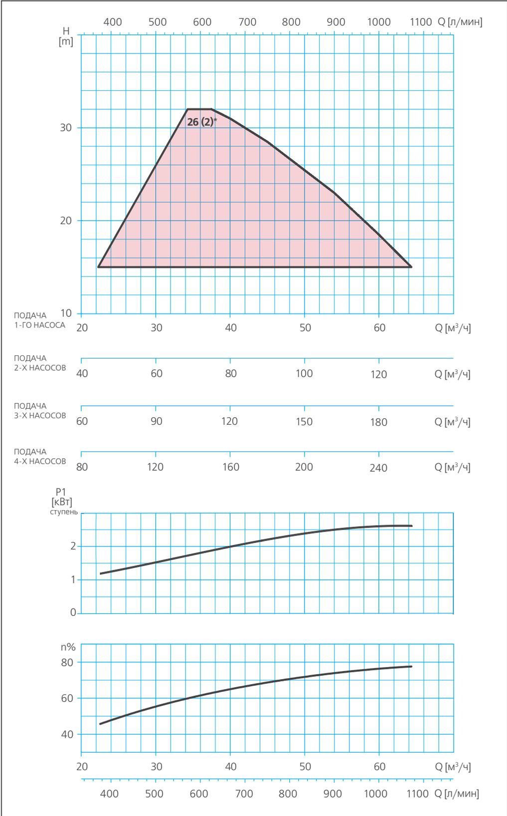
\* количество ступеней (рабочих колес) в насосе входящем в состав установки
